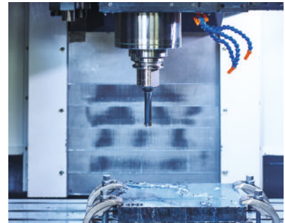
CNC makineleri için lütfen toz yüksek hızı seçin orta ve düşük hızlı delme için çelik serisi ve yüksek hızlı delme için karbür serisi.
